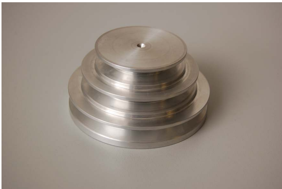
Obr. 3.6 Hotová součást ŘEMENICE
