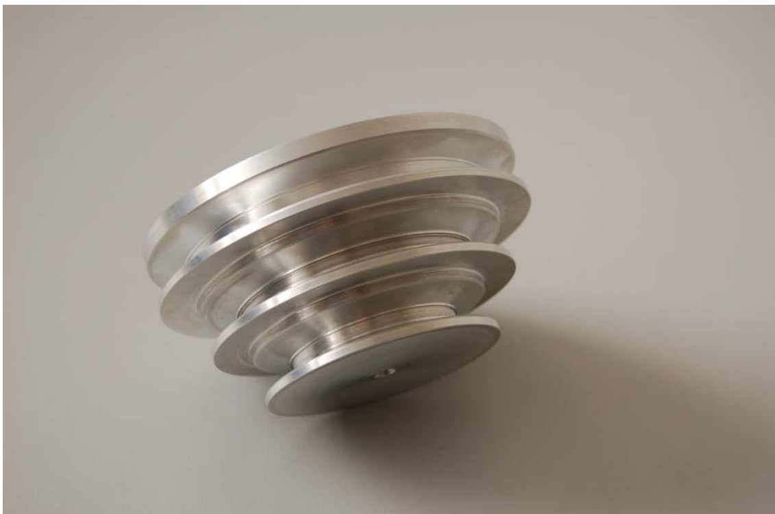
Obr. 3.7 Hotová součást ŘEMENICE
